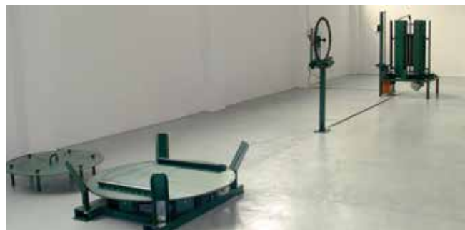
Infini-T™ 自动重卷系统生产布局
